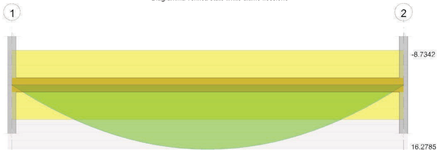
Diagramma verifica stato limite ultimo (solo permanenti) flessione
