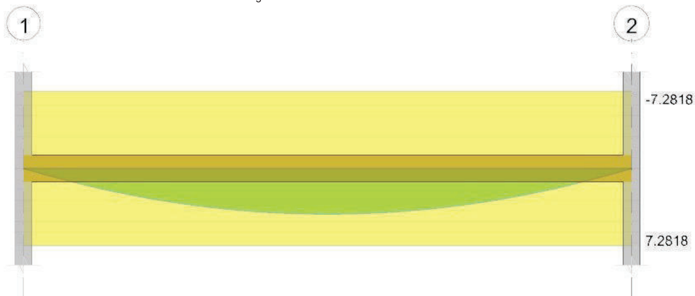
Diagramma verifica stato limite ultimo (solo permanenti) flessione
